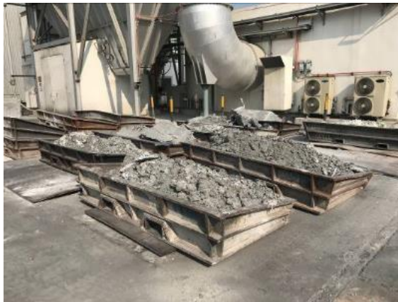
ถาดพักขี้ตะกรันอลูมิเนียม DROSS ก่อนนำไปจัดเก็บ
