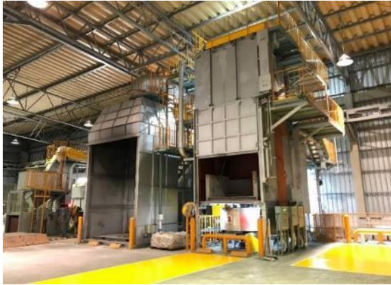
เครื่อง MRM สำหรับตั้งอลูมิเนียมในใช้ตะกรันอลูมิเนียม DROSS กลับไปหลอมใหม่
