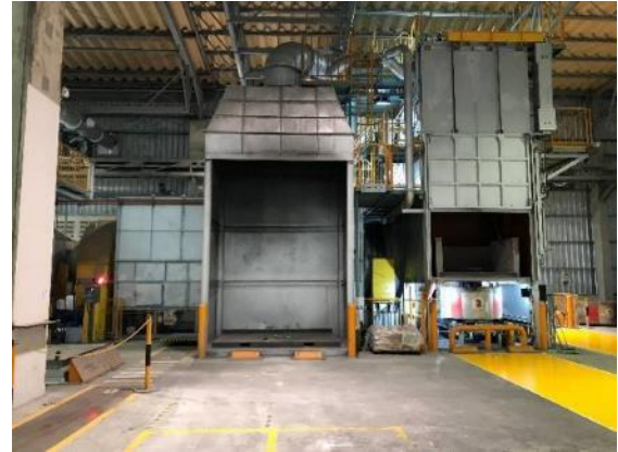
เครื่อง MRM สำหรับตั้งอลูมิเนียมในใช้ตะกรันอลูมิเนียม DROSS กลับไปหลอมใหม่
